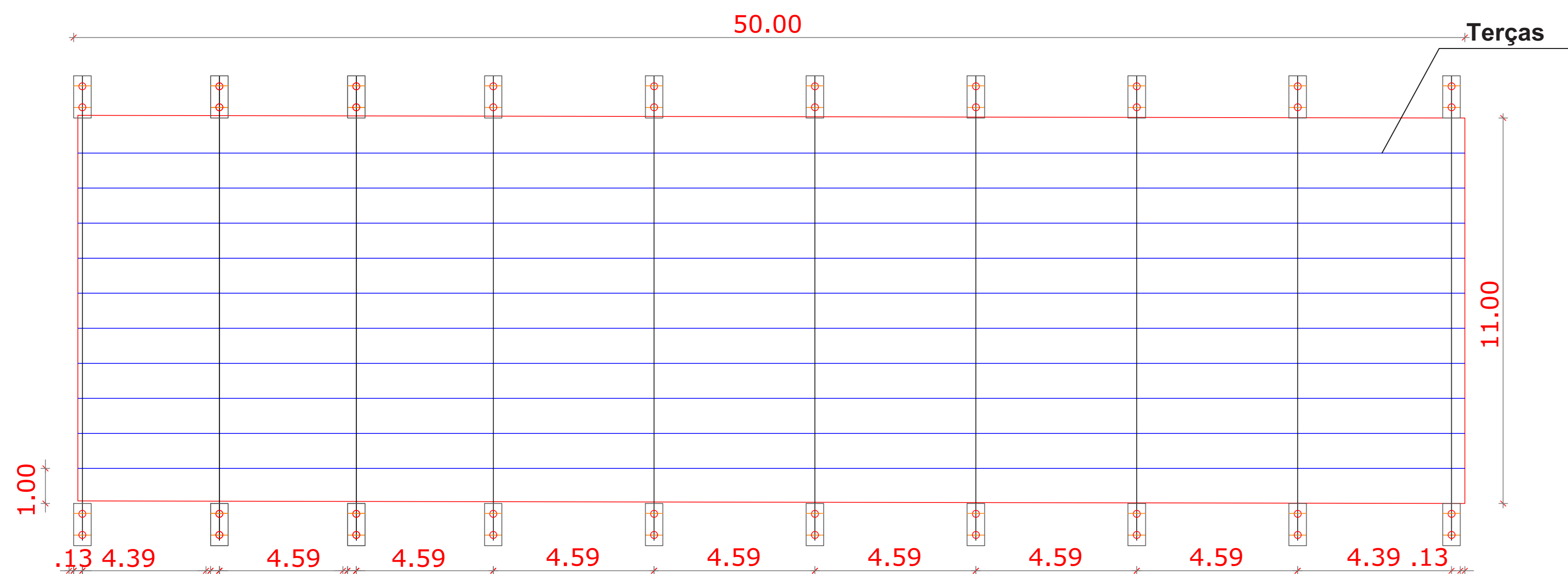
PLANTA DE LOCAÇÃO DAS TERÇAS ESCALA 1:50
